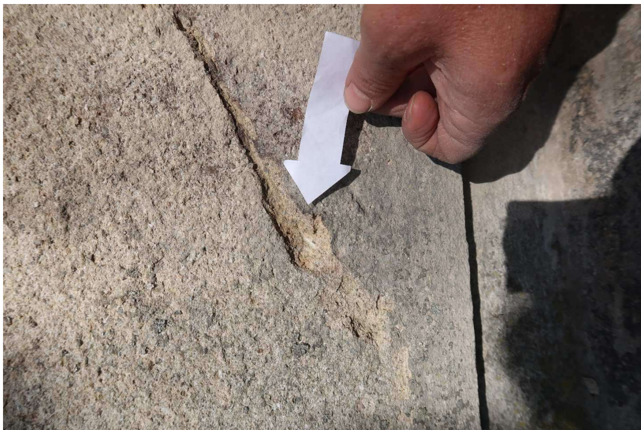
Stav před restaurováním – odběr vzorků z podstavce na zjištění salinity
